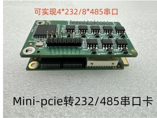
型号：Mini-Pcie-8COM-485 模块
